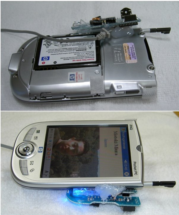
図 3. 実装したプロトタイプシステム。スタイラスの動作を取得するためイメージセンサを PDA に取り付けた。
