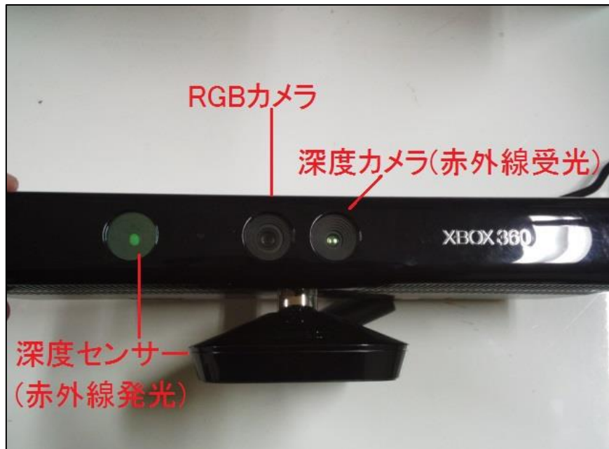
(図 3.2 Kinect に搭載されているカメラとセンサー)
