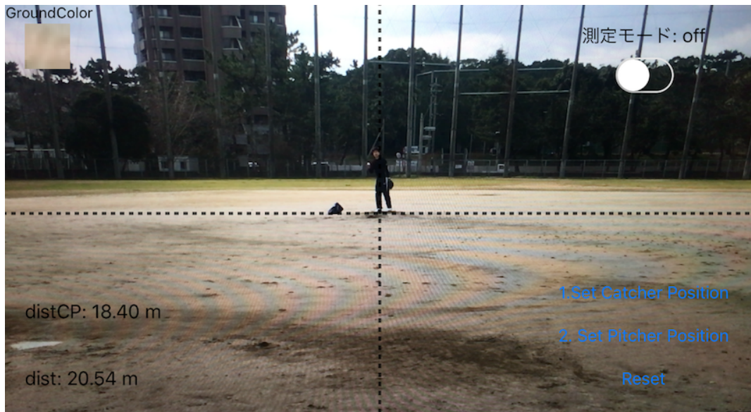
図 3.2: 距離測定の様子. 距離を測りたい対象の接地点を中央に写す.
