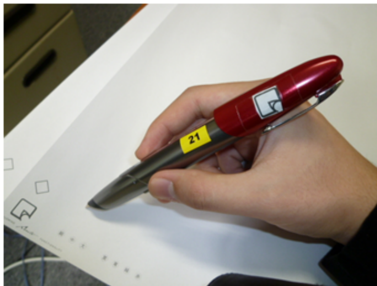
図 1.2: アノト方式デジタルペンとアノト用紙
