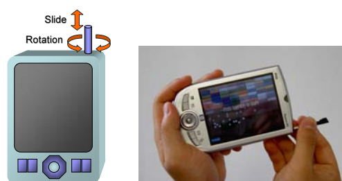
図 1: (左) ホルダに格納している間のスタイラス動作 (右) RodDirect による操作イメージ
